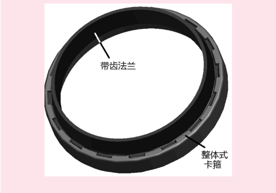
图 1 快开装置结构图
