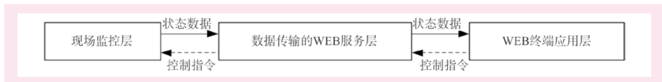
图2 智能型自动生产线实训平台的基本控制架构
