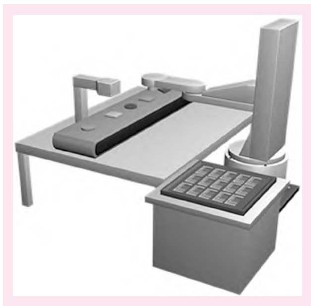
图 7 SCARA 装配站立体结构
