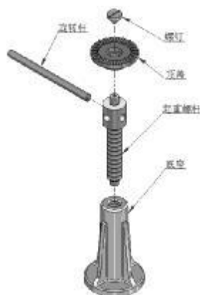
图1 螺旋千斤顶组成
