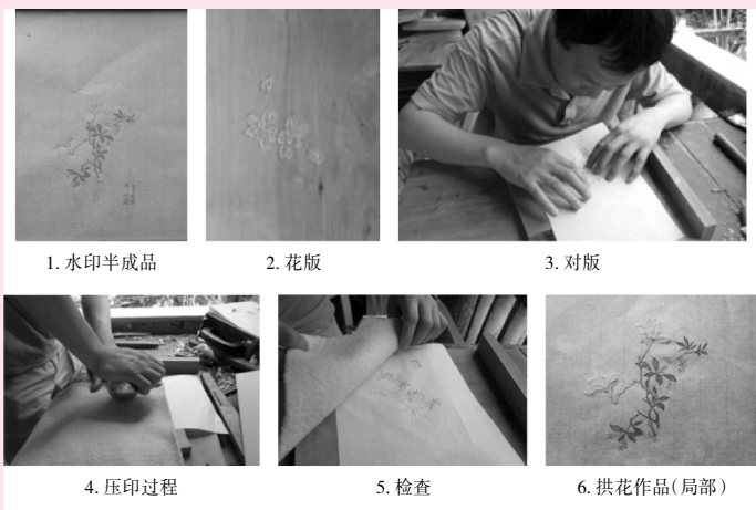
图1 拱花技术的压印流程
