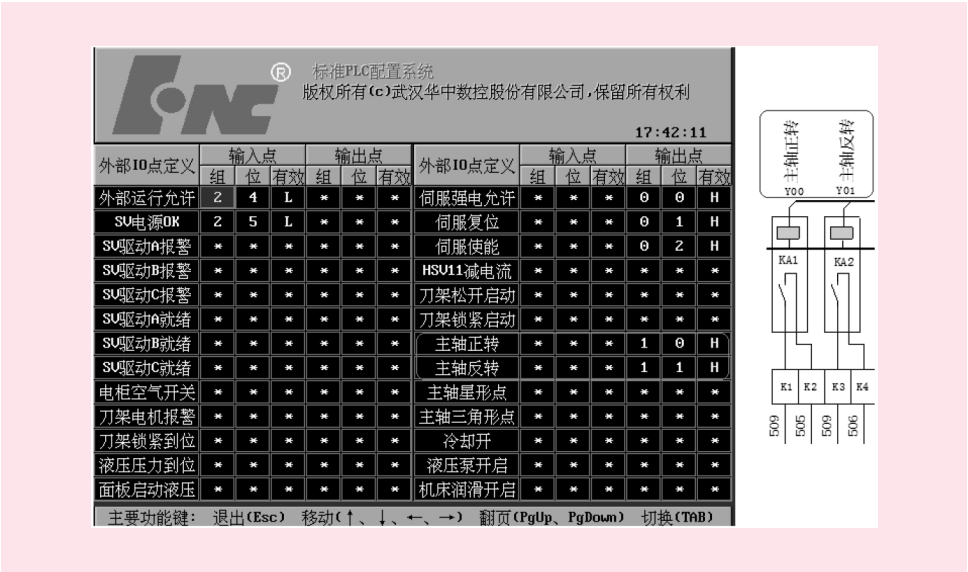
图 2 HNC-21TF 数控系统标准 PLC 配置系统
