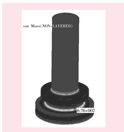
图5 有气孔缺陷时的应力云图
